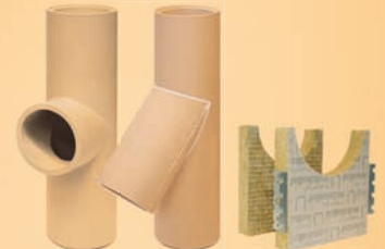
8 Ümar liitelement 90° ja 45° Kõrgus: 660 mm. Läbiviiguava sisemõõt võrdne lõõriavaga, va. 120 mm toru (liiteava 140 mm). Isolatsioon liitelemendile + kinnitused.
