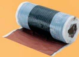
14 Tihenduslint Wakaflex. Polüisobutüleenist alumiiniumvõrguga armeeritud tihenduslint koos butüüllimiiribaga mõlemas servas.
